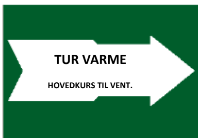
Figur 5-3 - Rørmerker med merkebånd som legges rundt røret med overlapp med individuell tekst med pil.
