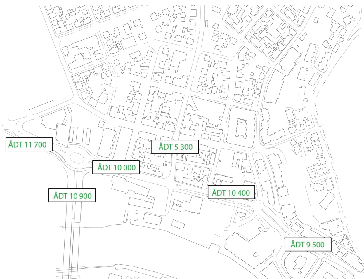
Figur 16: Dagens (2019-tall) trafikkmengde i planområdet og områdene rundt. Tall hentet fra Nasjonal vegdatabank.
