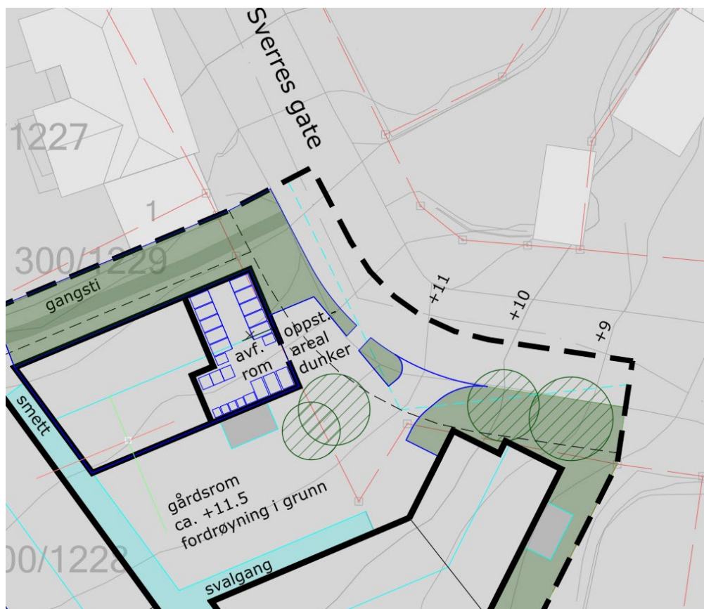
Fig 2 – utkast/prinsipppløsning, avfallsrom og oppstillingsareal
