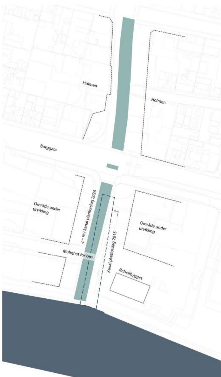
Figur 8 Illustrasjon som viser ny linjeføring av Veumbekken med den tidligere linjeføringen vist med stiplet linje
